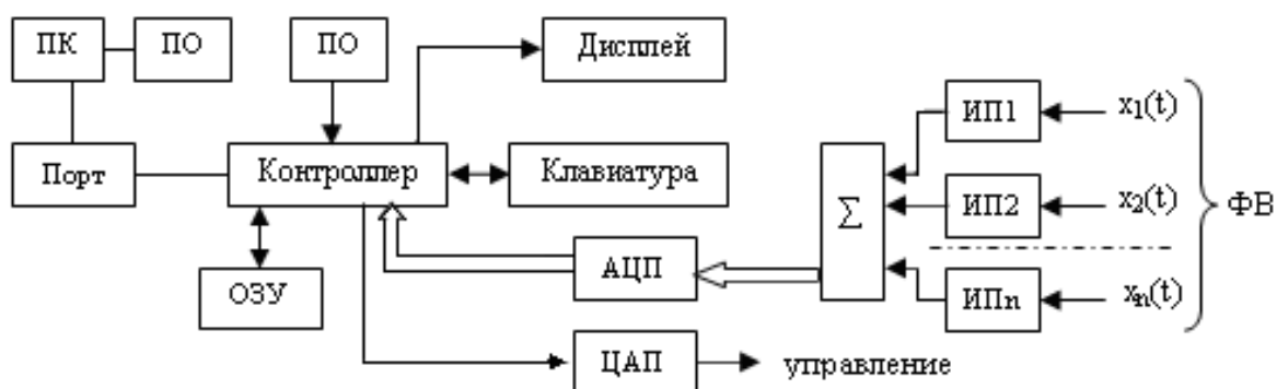
Рисунок 8 – Структурная схема ИИС с виртуальным прибором
